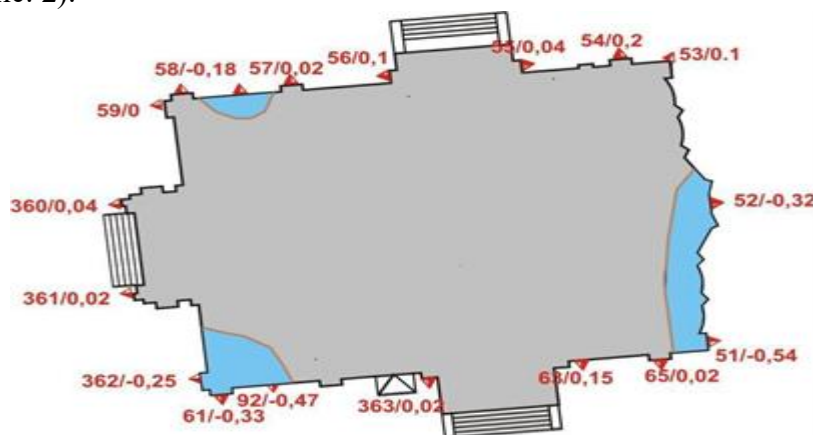
Рисунок 2. Схема скоростей деформаций конструктивных элементов Успенского собора в 2015 г. (в установившийся период)
